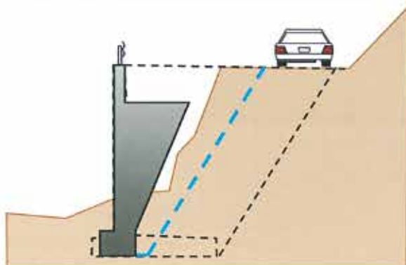
基礎掘削低減による現道の確保
