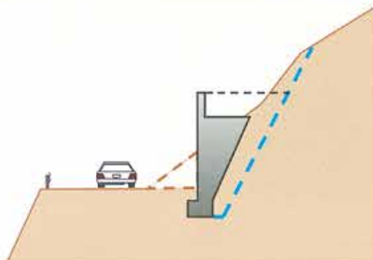
法面掘削低減による環境保護
